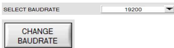
Unter **SELECT BAUDRATE** kann jetzt eine neue Baudrate ausgewählt werden. Durch Drücken von **CHANGE BAUDRATE** wird die neue Baudrate zum Sensor übertragen.
